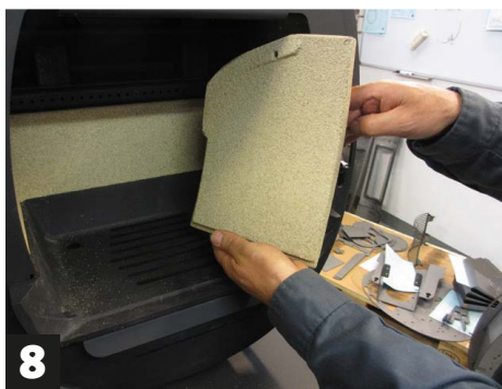
8 Høyre sideplate settes inn som den venstre
